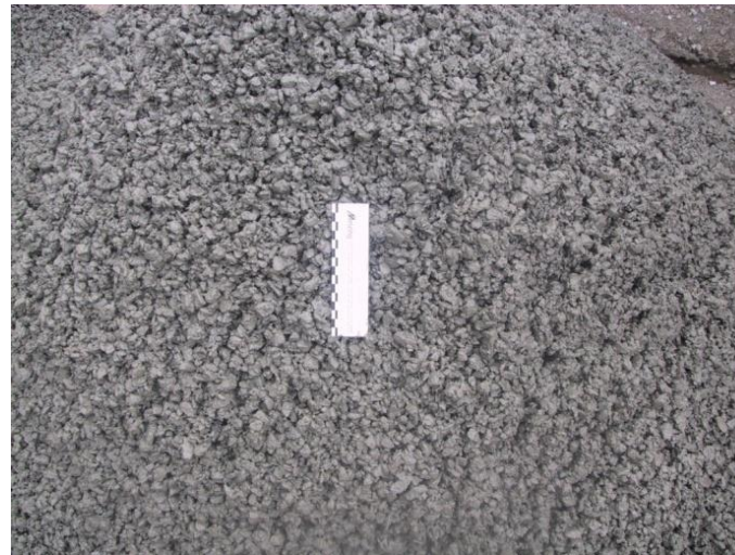
Konsistenz des Dränbetons
