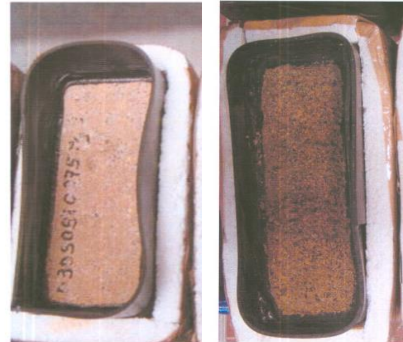
Intakte Betonsteinoberfläche nach der Prüfung
